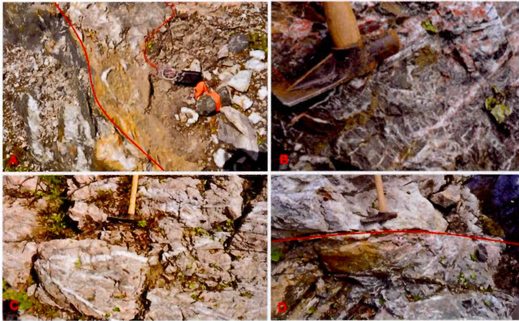
Figure 4.1: Minéralisation Cossette Sud. A : contact entre la monzonite et la zone chloritisée porteuse des veines de quartz minéralisé; B : zone bréchique minéralisée riche en chlorite et feldspath; C : veines stériles de quartz dans la roche encaissante monzonitique; D : contact net entre la zone bréchique minéralisée et l'encaissant monzonitique.
